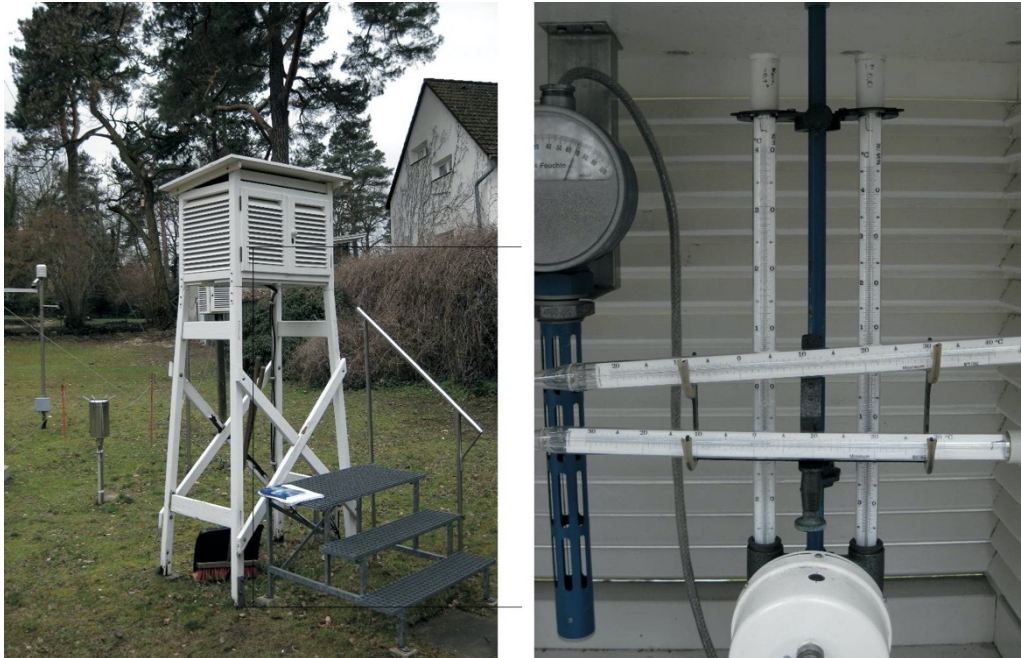
Abbildung 1 zeigt eine klassische, deutsche Wetterhütte (erweiterter Stevenson Screen) und (rechts) ein darin befindliches modernes Thermometerensemble gezeigt, wie es immer noch in vielfältiger Verwendung ist. Die senkrechten Thermometer sind (links) das Assmansche Aspirationsthermometer zur Temperaturmessung, rechts daneben ein befeuchtetes und belüftetes Psychrometer zur Messung der Luftfeuchte. Quer darunter befinden sich zwei liegende Thermometer zur Messung von Max. und Min. Temperaturen. Die runde Plastiktrommel enthält den Federmotor mit Ventilator zur Erzeugung des Luftstromes mit \varnothing 2,5 m/s vor und während der Messung. Im März 2009 vom Autor im Meteorologischen Institut der Freien Universität Berlin aufgenommen
