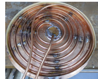
Aerosol-Platte - Rückseite mit der Kühlschlange
