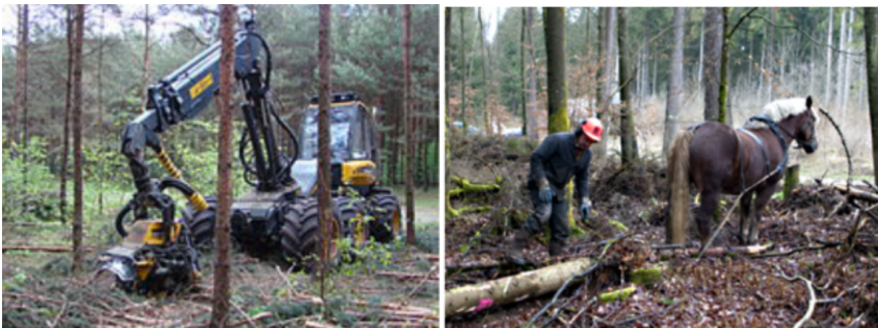
Bild 4: Die schweren Erntemaschinen brauchen feste Zufahrtswege mit drainiertem Untergrund und einen trockenen Waldboden, unzählige Ablaufgräben führen das Wasser aus dem Wald hinaus. Die Erntemaschinen verdichten zusätzlich den einst schwammigen, Wasser speichernden Waldboden.
