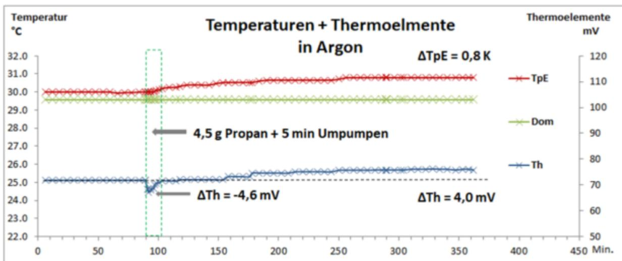
Abb. 3a: Propan-Experiment Nr. 6: Endkonzentration 2,0 Vol.-% Propan.
