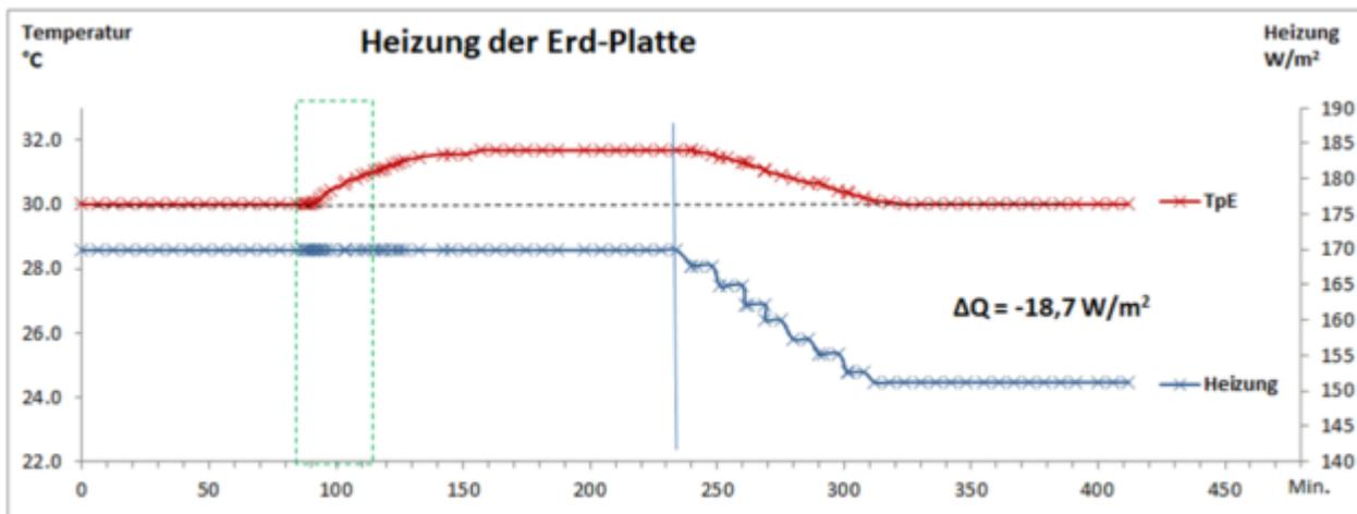
Abb. 7b: Nachweis des Isolations-Effektes von Freon 134a
