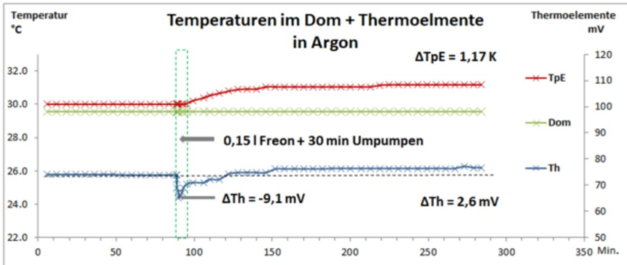
Abb. 4a: Freon-Experiment Nr. 13: Endkonzentration 0,13 Vol.-% Freon 134a
