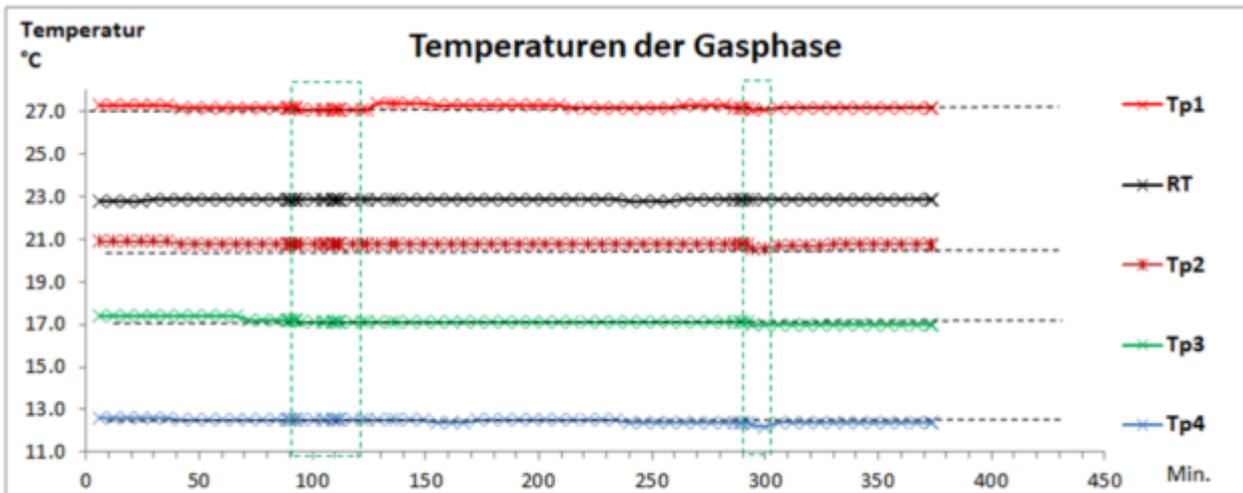
Abb. 2b: CO<sub>2</sub>-Experiment: Temperatur-Daten der Messfühler.
