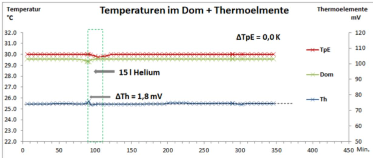
Abb. 6: Helium-Experiment Nr. 3: Endkonzentration 13 Vol.-% Helium
