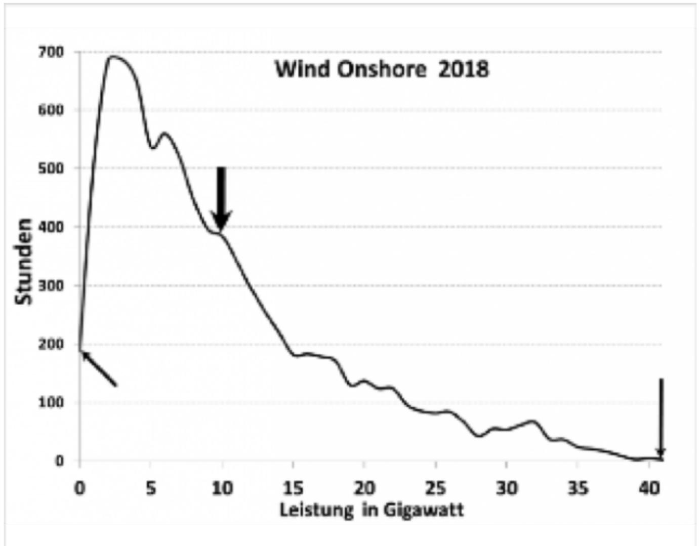
Große Fluktuationen von Windstrom: Anzahl der Stunden des Jahres 2018 in Abhängigkeit von der Einspeiseleistung aller Windkraftanlagen an Land in Deutschland. Grafik Rolf Schuster
