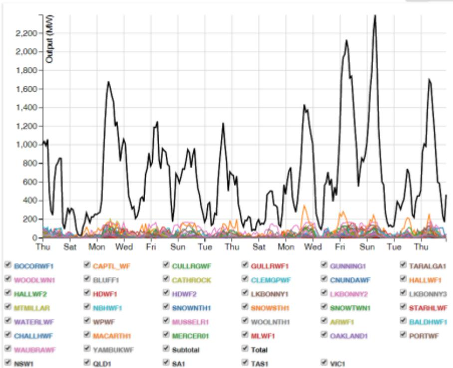
Die Grafiken die oben (und unten) zu sehen sind, stammen von der Website von [Aneroid Energy](#) und zeigt die gesamte Leistung aller Windkraftanlagen, die an das Östliche Stromnetz in Australien angeschlossen
