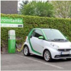
Dieses Techno-Kürzel beschreibt keine Energiewandlung wie zum Beispiel "P2H" (Strom zu Wärme) oder "P2G" (Strom zu Gas), sondern meint ein Konzept zur Stromspeicherung. Eine Vielzahl mit dem Netz verbundener E-Fahrzeuge könnte überschüssigen Strom kurzfristig einspeichern und bei Bedarf als Schwarmstrom auch ans Netz zurückgeben. „Bidirektionales Laden“ lautet dafür der Fachbegriff.
