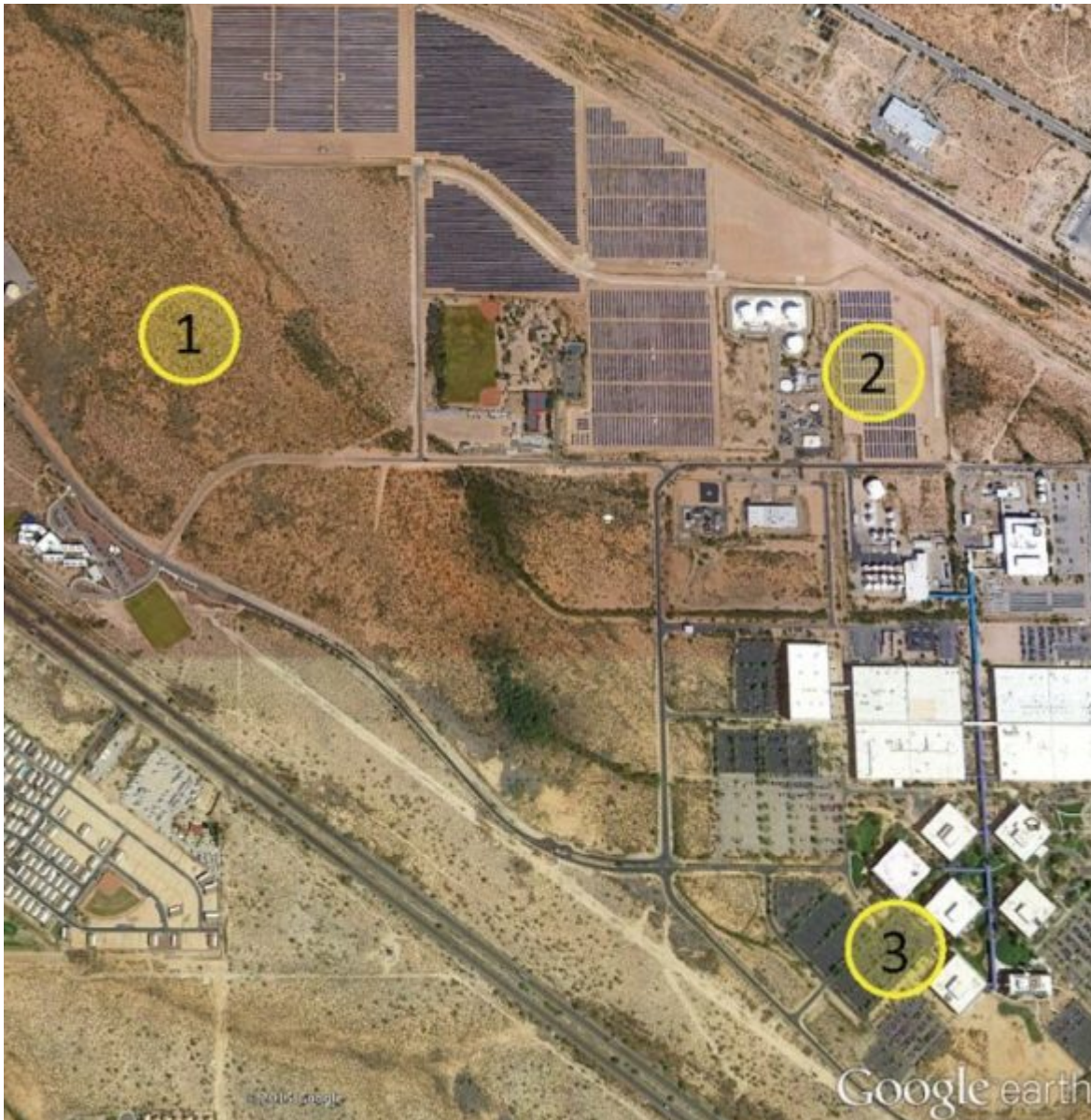
Abbildung 4. Experimentelle Standorte. Die Überwachung eines (1) natürlichen semiariden Wüstenökosystems, (2) einer Solaranlage (PV) und (3) eines „städtischen“ Parkplatzes – der typischen Quelle städtischer Wärmeinseleffekte – innerhalb eines 1 km 2 großen Gebiets ermöglichte eine relative Kontrolle der einfallenden Solarenergie, so dass wir die Variation der lokalen Temperatur dieser drei Umgebungen über einen Zeitraum von einem Jahr quantifizieren konnten. Das Google Earth-Bild zeigt die Solarzone des Wissenschafts- und Technologieparks der University of Arizona .
