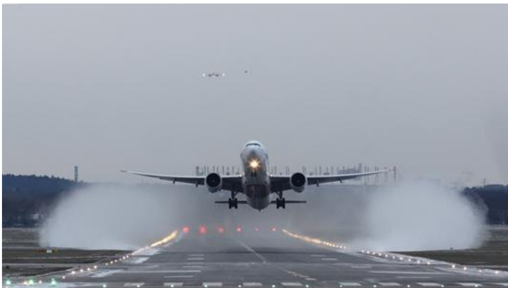
Abbildung 10 zeigt die Luftverwirbelung und deren Verteilung bei einem kleineren, startenden Verkehrsflugzeug.
