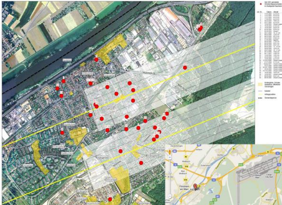
Wirbelschleppenschäden im Stadtgebiet Raunheim
