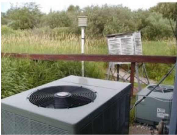
Abbildung 3(links): Englische Hütte und moderne Messstation am Messort Detroit Lakes USA, kurz vorher aufgenommen und ins Netz gestellt am 25.07.07 von A. Watts; (rechts) Temperaturverlauf aus der GISS Datenbank zur Messstelle Detroit Lakes USA
