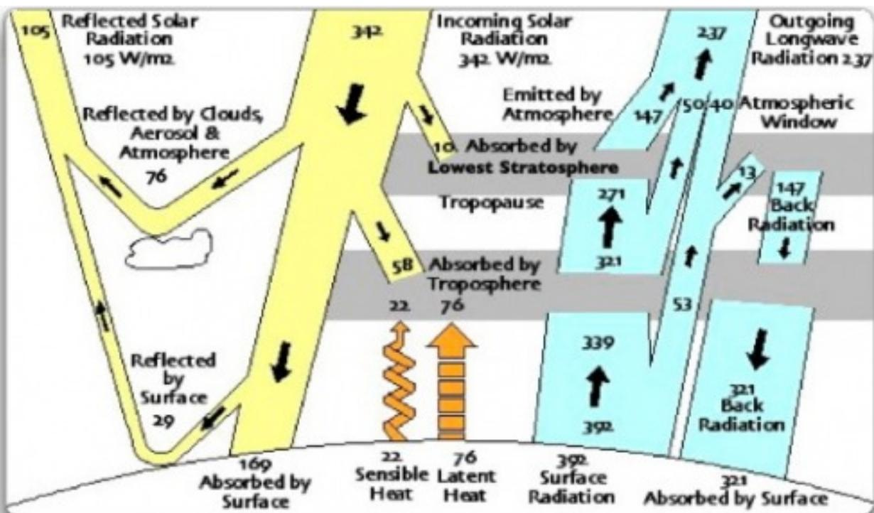
Abb. 1. Globale Energiebilanz, von [Kiehl/Trenberth](#) angepasst und erweitert. Die Werte sind Watt pro qm ( $W/m^2$ ). Beachte die Emission von  $147 W/m^2$  am oberen Atmosphärenrand (emitted by Atmosphere). Die Tropopause ist die Höhe, wo die Temperaturabnahme mit der Höhe aufhört.
