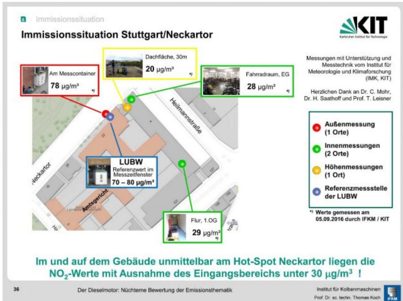
Bild 4. Schon auf dem Dach sowie innerhalb des Gebäudes, das direkt an der Messstelle „Am Neckartor“ steht, liegen die Werte weit unterhalb kritischer Bereiche (Grafik: IFKM/ KIT)
