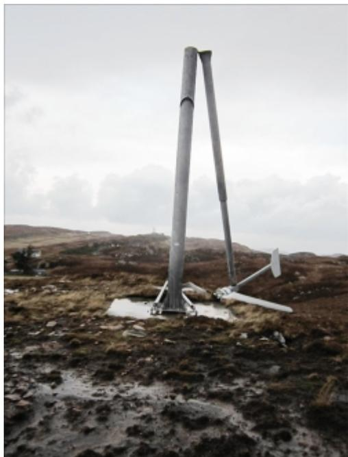
Bild: Der Turbinenmast brach in der Mitte durch. In der Folge stürzten das Gehäuse und die Rotorblätter zu Boden.
