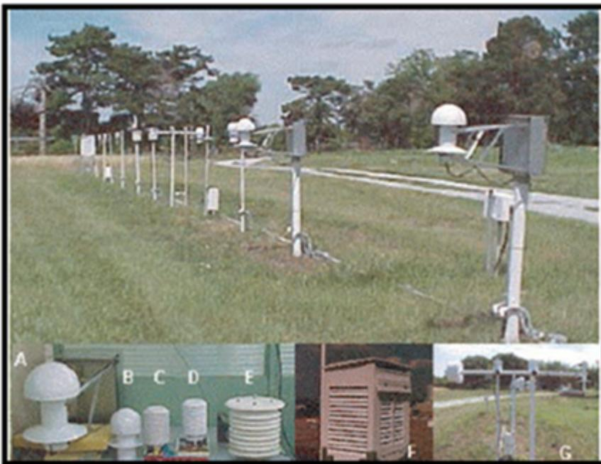
**Abbildung 7: Kalibrierungs-Experiment an der University of Nebraska in Lincoln (aus (11), Abbildung 1); E, MMTS shield; F, CRS shield; G, the aspirated RM Young reference.**
