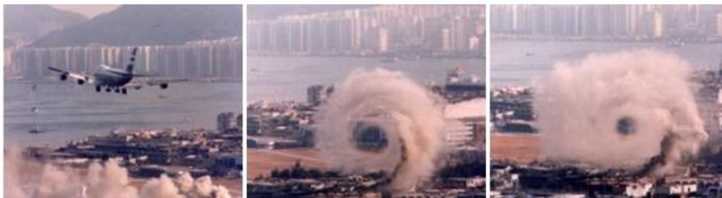
Die Bilderserie in Abbildung 11 zeigt die sichtbar gemachte und sich ausbreitende Wirbelschleppe eines anfliegenden Großraumflugzeuges (Boeing 747).
