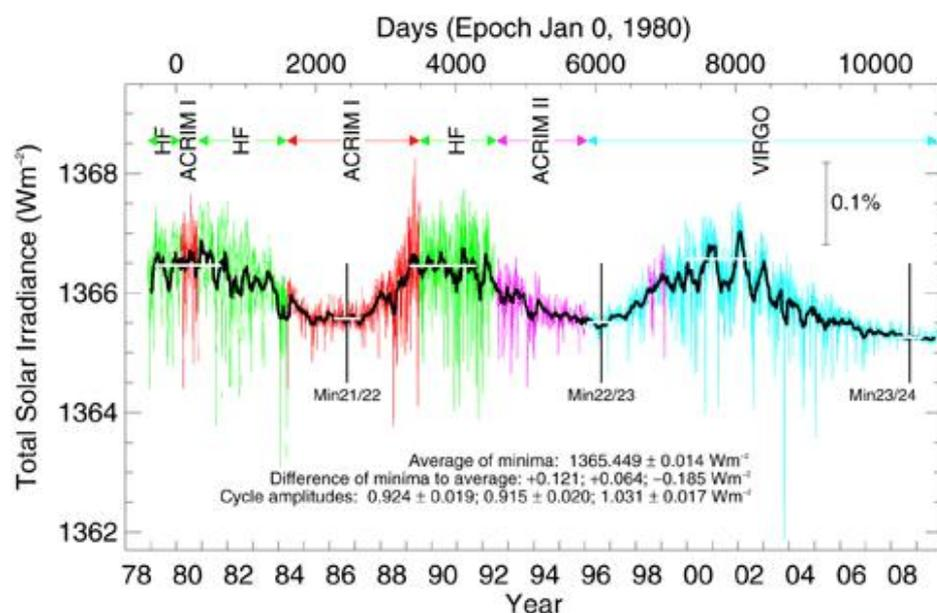
Die Abbildung 10 zeigt den TSI im Zeitraum 1979 bis Januar 2010 (Quelle: <http://www.pmodwrc.ch/pmod.php?topic=tsi/composite/SolarConstant>). In der Zeile oben sind die verschiedenen Messsysteme, mit denen der TSI aufgenommen wird (wurde) genannt. So steht z.B. ACRIM für Active Cavity Radiometer Irradiance Monitor. Es ist zu sehen, dass im Messbereich des TSI keine Aktivitätssteigerung der Sonne im Betrachtungszeitraum erkennbar ist, wohl aber in der Abbildung 11 und der Abbildung 8 links.
