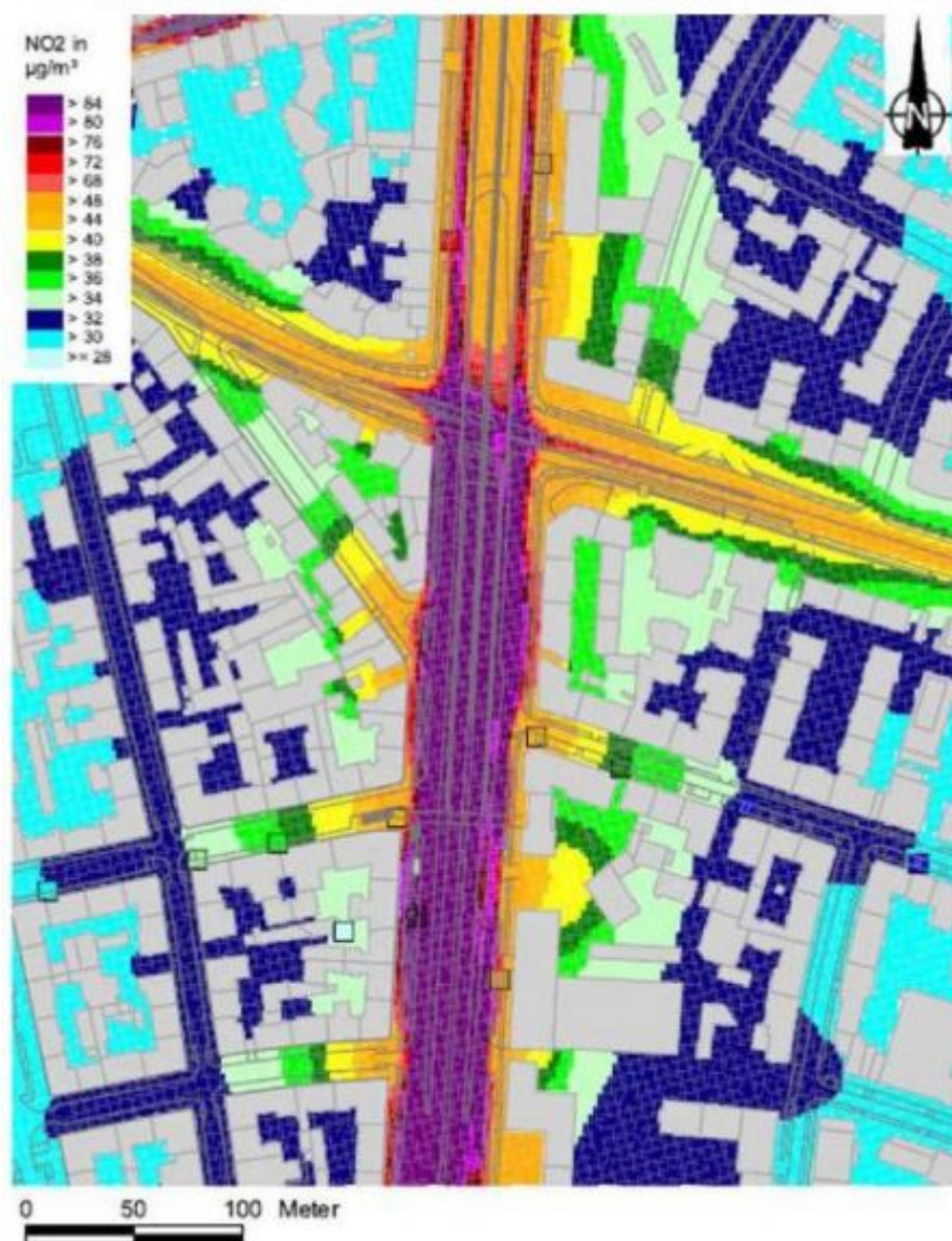
Bild 4. Darstellung der Jahresmittelwerte der NO 2 -Konzentration im Bereich des am stärksten beaufschlagten Abschnitts der Landshuter Allee in München für das Jahr 2011 (Grafik: [BLFU])
