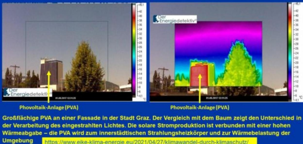
Abbildung 3: Photovoltaik-Anlagen werden zu innerstädtischen Strahlungsheizkörpern
