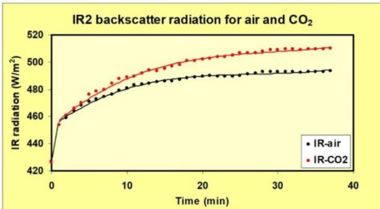
Abbildung 8: Die Rückstreuung (erhöhte IR-Strahlung, gemessen mit IR2), die von der Rückwand der Box empfangen wird, stieg um 17 W/m<sup>2</sup> mit CO<sub>2</sub> in der vorderen Box. Die Erwärmung erfolgt über die Al-Folie.
