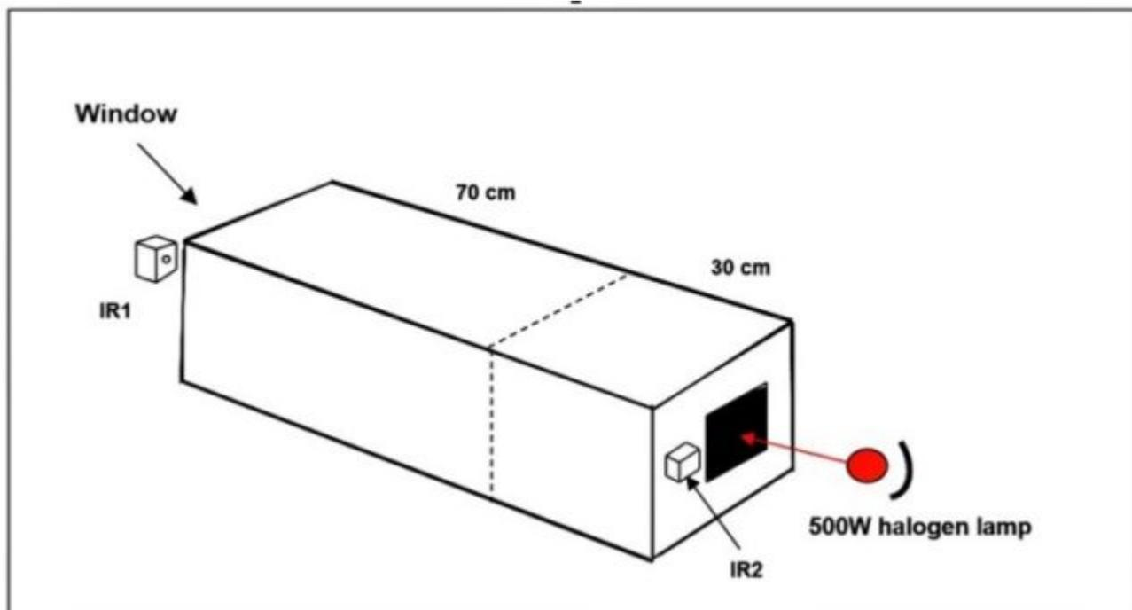
Abbildung 1: Der Experiment-Aufbau
