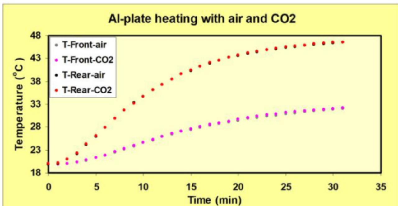
Abbildung 5: Dargestellt ist die Erwärmung der Luft (mit ca. 400 ppm CO<sub>2</sub>) in der hinteren Kammer (obere Kurve). Die Kurve ist nahezu identisch, wenn Luft (schwarze Punkte) durch nahezu 100 % CO<sub>2</sub> (rote Punkte) in der vorderen Kammer ersetzt wird. Die Erwärmung von Luft
