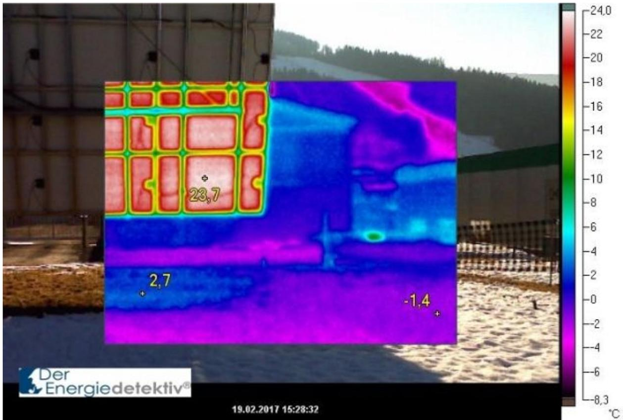
Photovoltaikanlage in ca. 870 m Seehöhe, Mitte Februar, Schnee am Boden, starker Wind und Lufttemperatur um den Gefrierpunkt. Die Sonne steht tief im Westen, die Solarfläche erreicht dennoch Temperaturen, die um mehr als 20 Grad über der Lufttemperatur liegen. Diese Wärme wird an die Umgebungsluft abgegeben und trägt zum Temperaturanstieg der Atmosphäre und verfrühter Schneeschmelze bei
