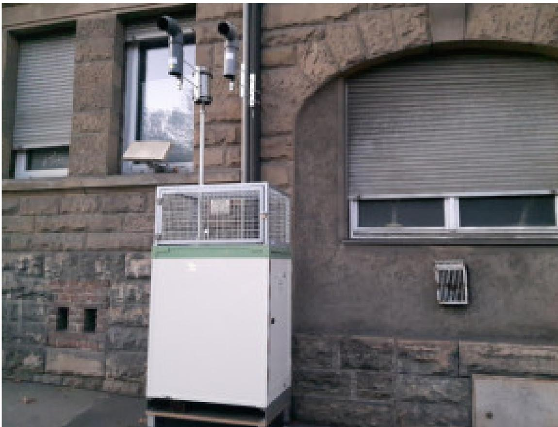
Messstation mit Gas-Entlüftung, Bild Autor
