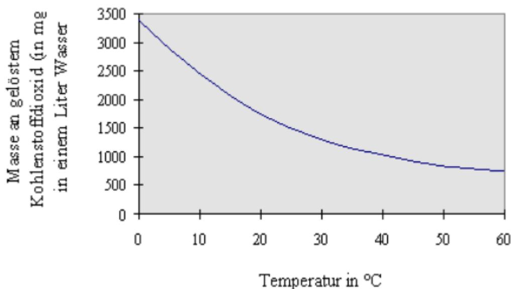
Pro Kelvin gasen rund 0,06 g CO<sub>2</sub> aus einem Kilogramm Wasser aus.
