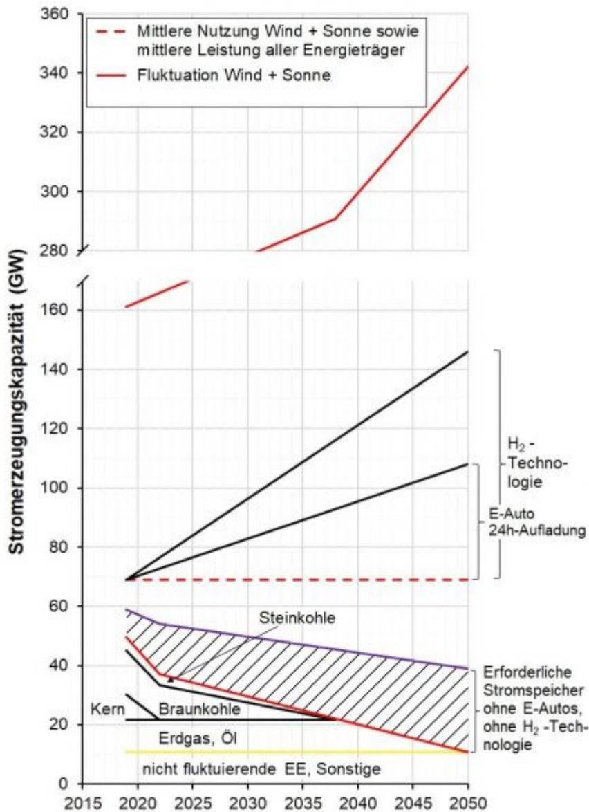
Bild 1: Stromerzeugungskapazitäten der verschiedenen Stromerzeuger 2019 bis 2050
