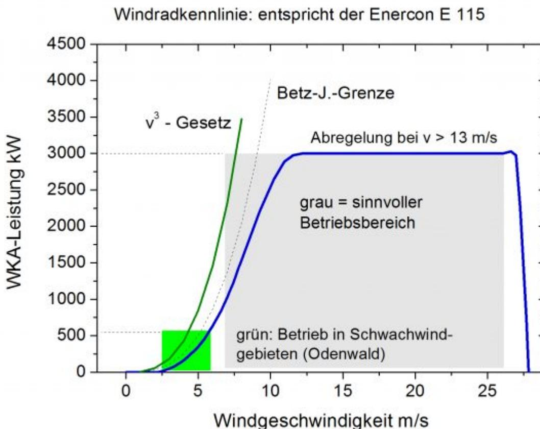
Bild 4: Beispiel einer Windradkennlinie (blau). Das  $v^3$  Gesetz und die *Betz-Joukowski-Grenze* werden prinzipiell von einem Windrad nicht erreicht. Die mittleren Windgeschwindigkeiten an der *Nordseeküste* liegen bei 5,8 bis 5,9 m/s, für Offshore *Nordsee* um die 9 m/s. Selbst Offshore-Windgeschwindigkeiten lassen daher die Nutzung des sinnvollen Betriebsbereichs von Windturbinen (grau) nur eingeschränkt in dessen linken Randbereich zu.
