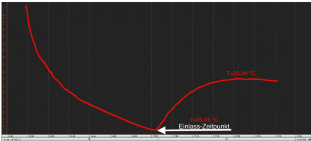
Abbildung 5 Reaktion Messsensor auf Kohlendioxid im Laborversuch
