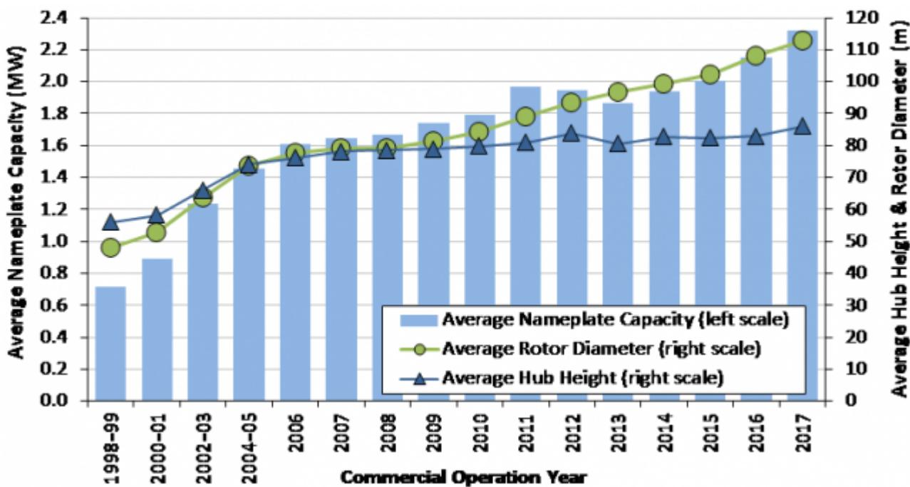
Wie in Deutschland, die Anlagen werden immer höher und die Flügel immer länger, dadurch, Erhöhung der Nennleistung
