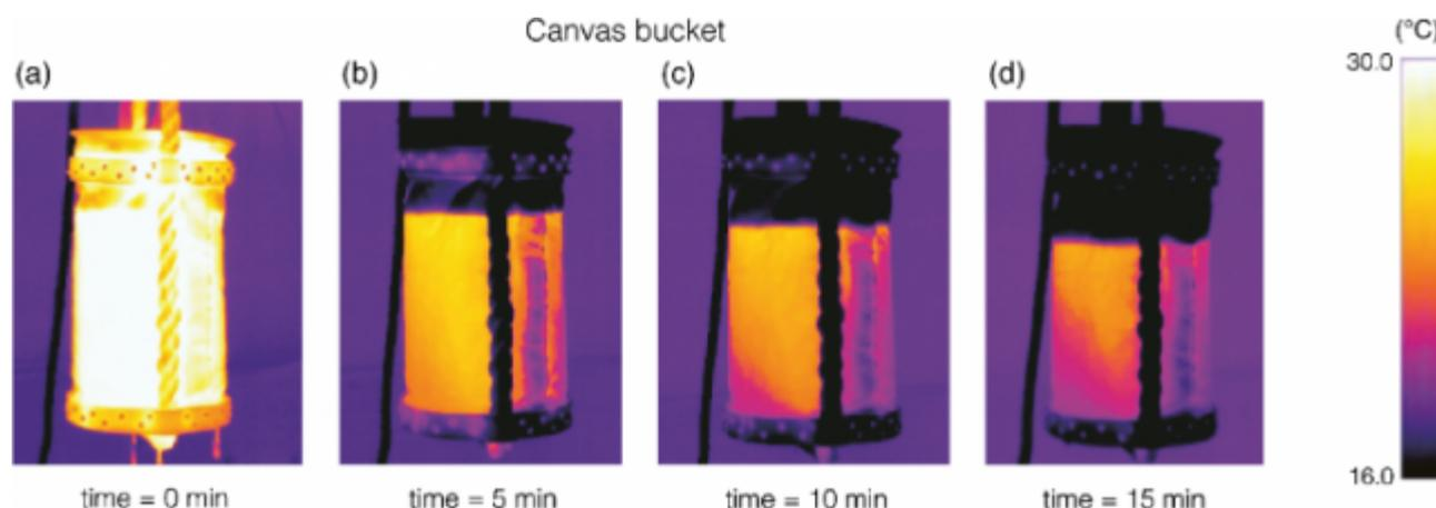
Abbildung 3 (a) bis (d). Thermische Bilder in 5-Minuten-Intervallen in einem Stoffeimer des Met.Office, der mit warmem Wasser gefüllt ist und vor einem Ventilator rechts in diesen Bildern montiert ist. Der Eimer wird nicht bewegt und der Deckel ist geschlossen.
