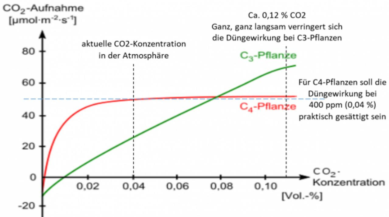
Abhängigkeit der Photosyntheserate von der CO<sub>2</sub>-Menge in der Luft bei C<sub>3</sub>- und C<sub>4</sub>-Pflanzen.
