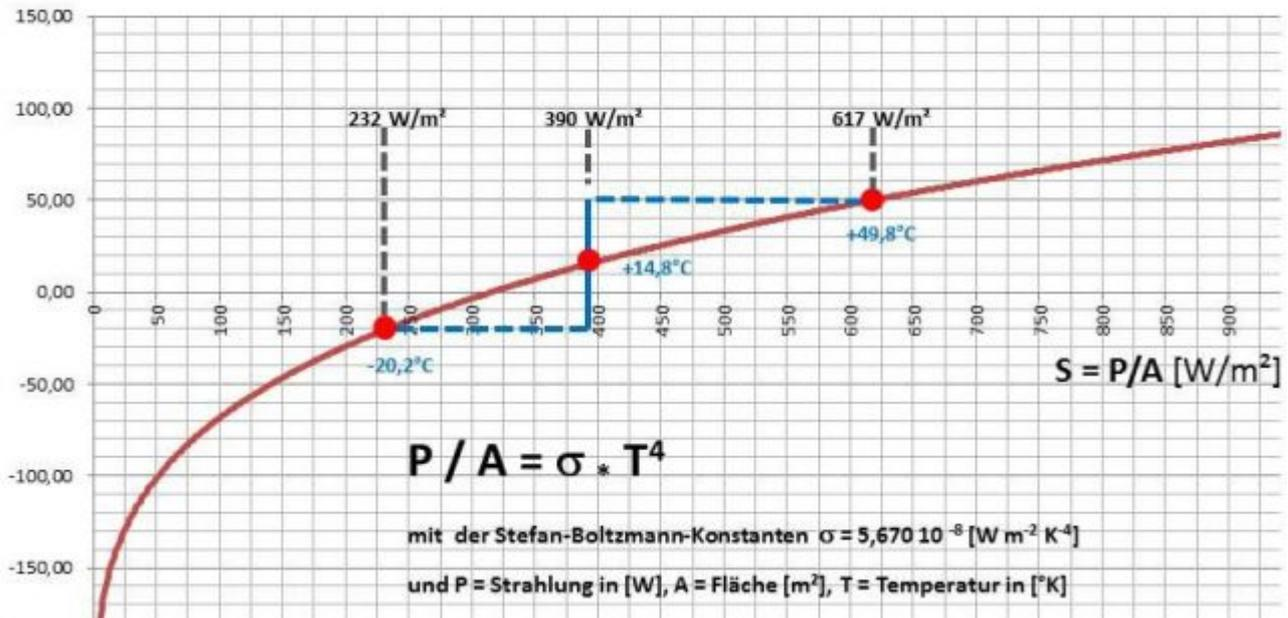
Wie bei einem  $T^4$ -Gesetz zu erwarten ist, erhöht sich das individuelle S-B Strahlungsäquivalent mit ansteigenden Temperaturen überproportional. Wir erhalten für die ausgewählten Temperaturen damit folgende S-B Strahlungsäquivalente:
