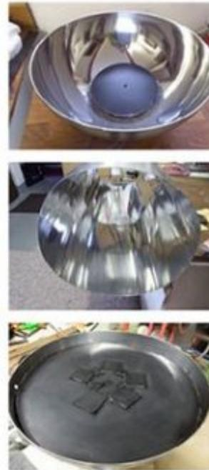
Abbildung 2: Links: Schematischer Aufbau des Experimentes; Rechts: von oben nach unten: Erd-Platte, Aluminiumröhre und Aerosol-Platte
