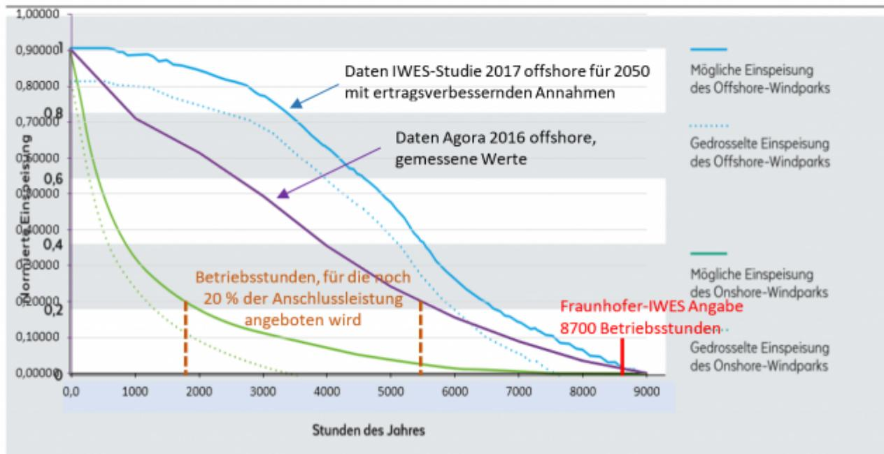
Bild 9; Bild Betriebsstunden Windkraft aus der IWES-Ergänzungsstudie 2017 [3] (Abbildung 15). Zum Verlauf „Normierte Einspeisung“ vom Autor darüber kopiert die normierte Einspeisung im Jahr 2016, berechnet aus den Agora-Daten, sowie erklärende Zufügungen
