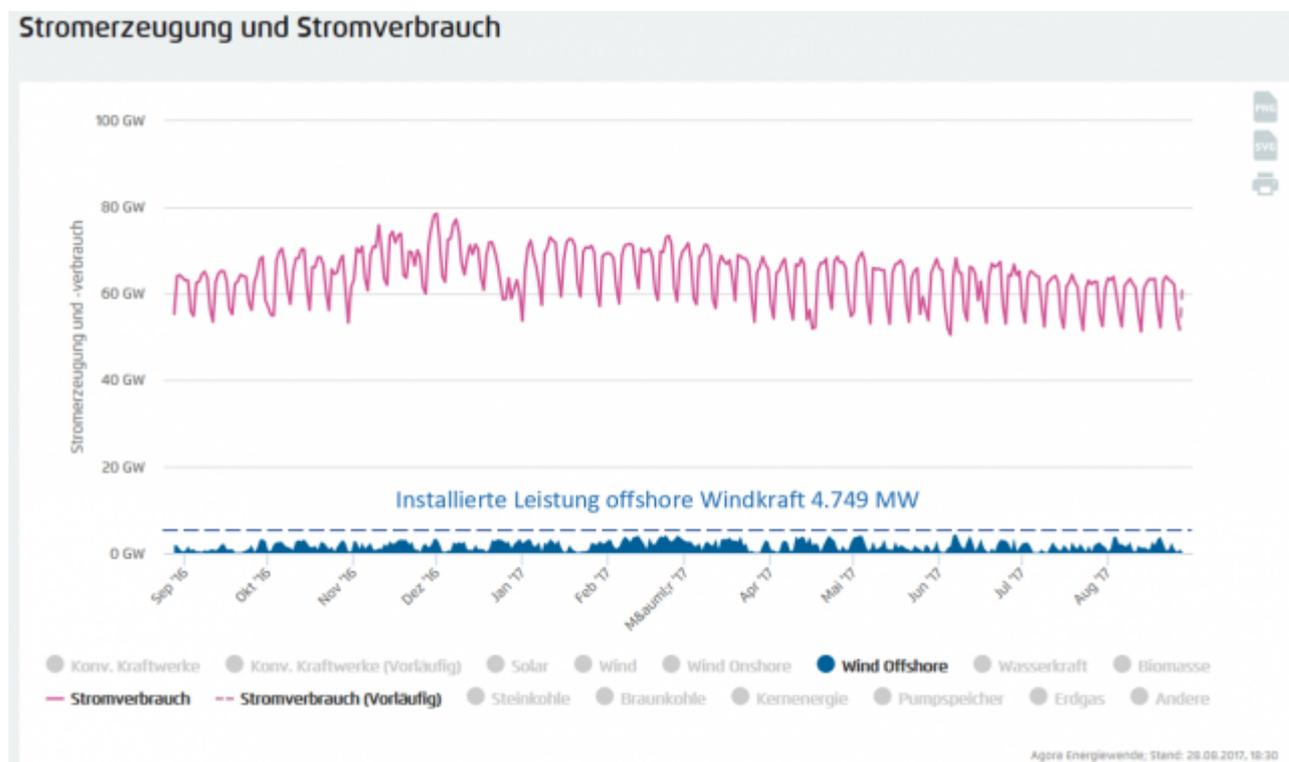
Bild 1 Offshore Windkraft Ganmlinien eines Jahres bis zum 28.08.2017. Blau: Windenergie offshore, Rot: Verbrauch. Vom Autor um die Ende 2016 installierte Anschlussleistung ergänzt. Quelle: Agora-Viewer
