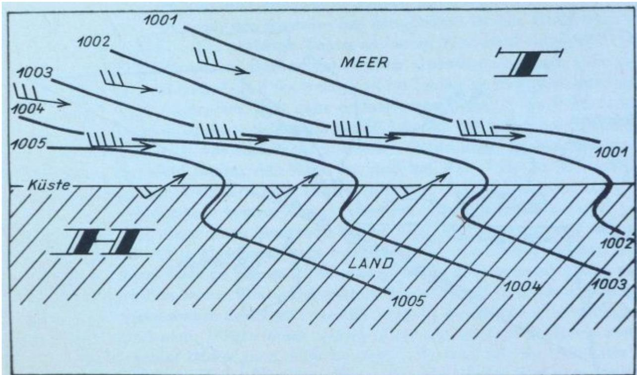
Abb. 3.45 Schema des Störungsfeldes einer Steilküste (nach Rodewald)
