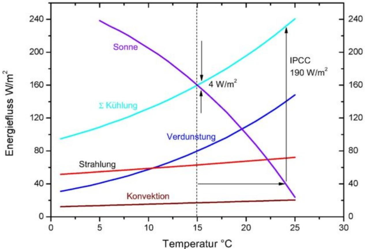
Bild 2: Energieflüsse und globale Mitteltemperatur
