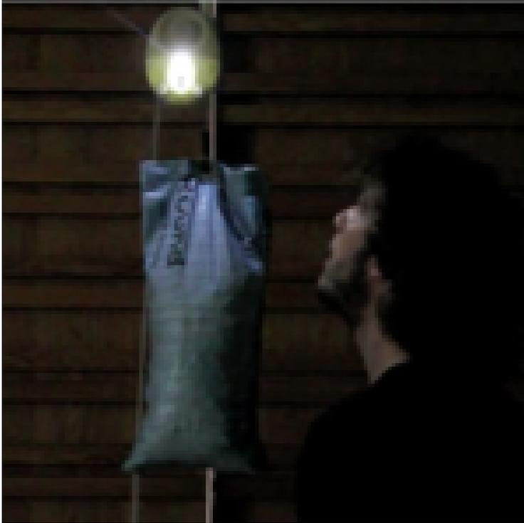
Bild 2 Screenshot mit Bild der Lampe im Betrieb. Der Sack mit dem Gewicht treibt den Generator an und muss dazu etwa alle 20 Minuten hochgezogen werden. Quelle: Werbevideo [3]
