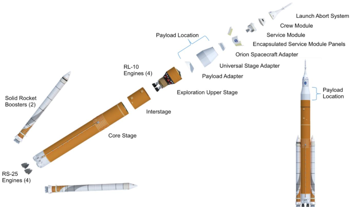
Die NASA sammelt Informationen, um die Machbarkeit potenzieller Nutzlasten auf dem zweiten Testflug der Space Launch System-Rakete zu ermitteln, die innerhalb des Universal-Stufen-Adapter montiert werden würde. Credits: NASA
