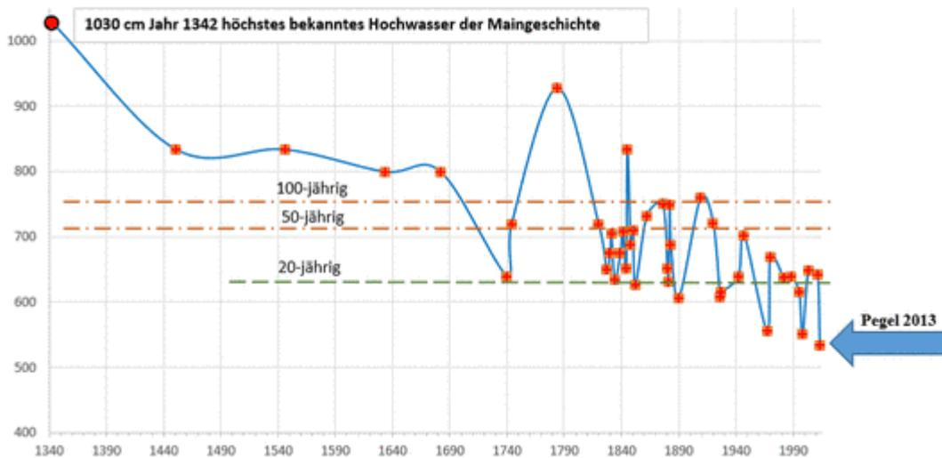
Bild 8 Hochwasserverlauf des Main bei Würzburg von 1340 -2014 (Grafik anhand der Daten aus Würzburg erstellt)
