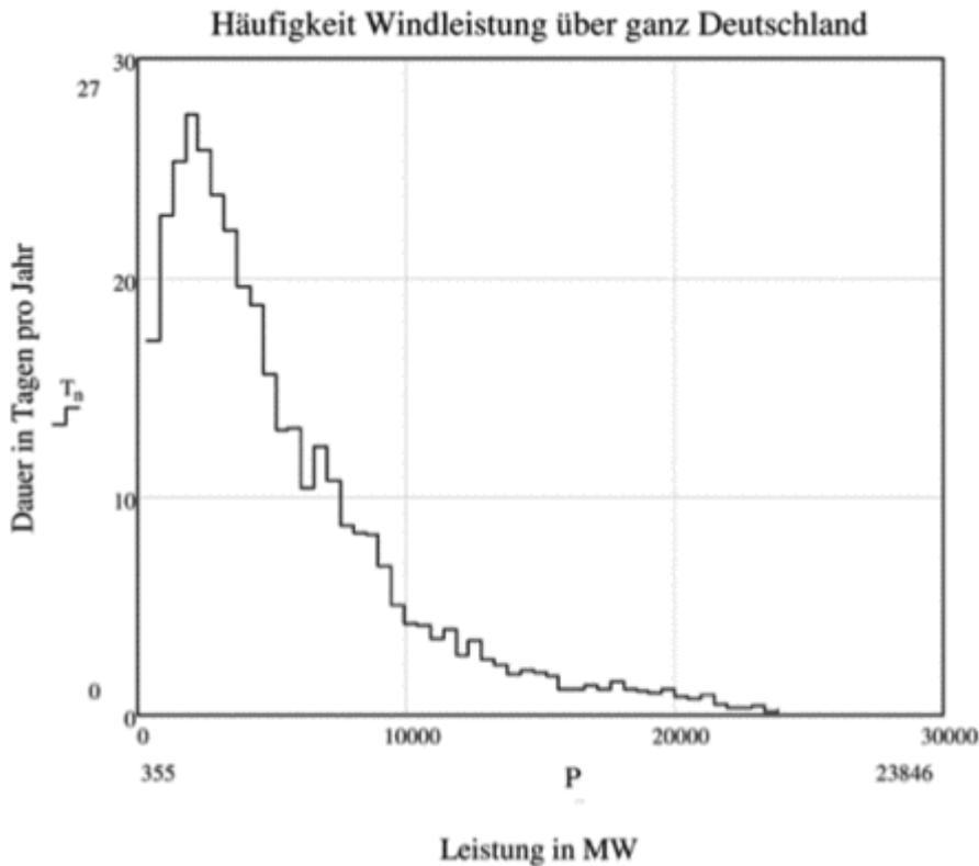
Abbildung 1: Verteilung der Summeneinspeisung in Deutschland Quelle: <http://www.vernunftkraft.de/windkraft-versus-wuerfeln/>
