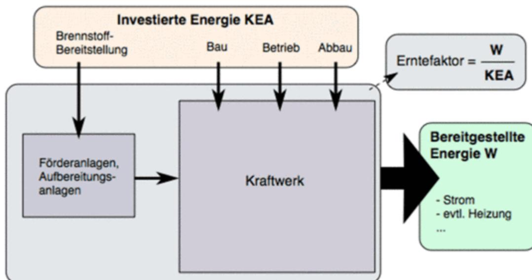
**Bild 1.** Der Erntefaktor eines Kraftwerks. Die Brennstoffbereitstellung
