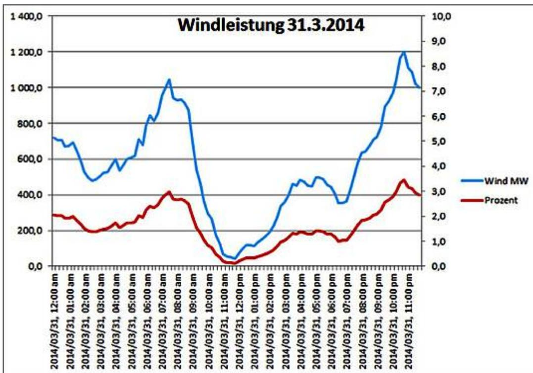
**Bild 1:** Schwachwind-Situation beim Windstrom am 31. März 2014. Bei einer installierten WEA-Leistung von 34950 MW wurden zeitweise nur lächerliche 50 MW und weniger geliefert. Ohne konventionelle Kraftwerke wären in Deutschland
