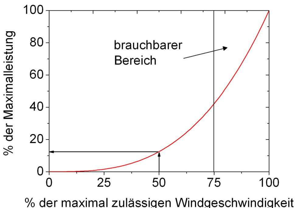
Bild 1: Nur ausreichend hohe Windgeschwindigkeiten erlauben eine akzeptable Leistungsabgabe des Windrads. Ein Windrad, wie z.B. die weiter unten erwähnte Enercon E-92 ist für die Nennleistung aus rund 14 m/s Windgeschwindigkeit ausgelegt (bei anderen Typen ändert sich dieser Wert). Weht der Wind nur halb so stark, also mit 7 m/s, liefert die E-92 nur noch den Bruchteil von  $1/(2 \cdot 2 \cdot 2)$  oder 12,5% der Nennleistung.
