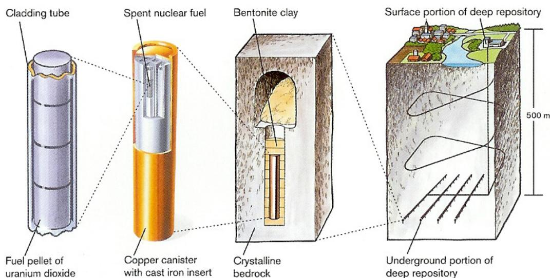
Bild 6. Die abgebrannten Elemente werden in dickwandigen Kupferzylindern versiegelt und in einer isolierenden Bentonitpackung in großer Tiefe in Granitkavernen eingelagert (Grafik: SKB)
