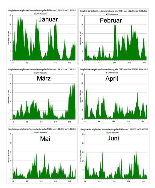
Die Verfügbarkeitsproblematik sei anhand der Leistungs- ganglinien der zeitgleichen Leistungseinspeisung in den ersten 6 Monaten 2012 aller Windenergieanlagen in Deutschland, die geamte installierte Leistung betrug 29.185 MW bei 22.664 Anlagen, erläutert:
