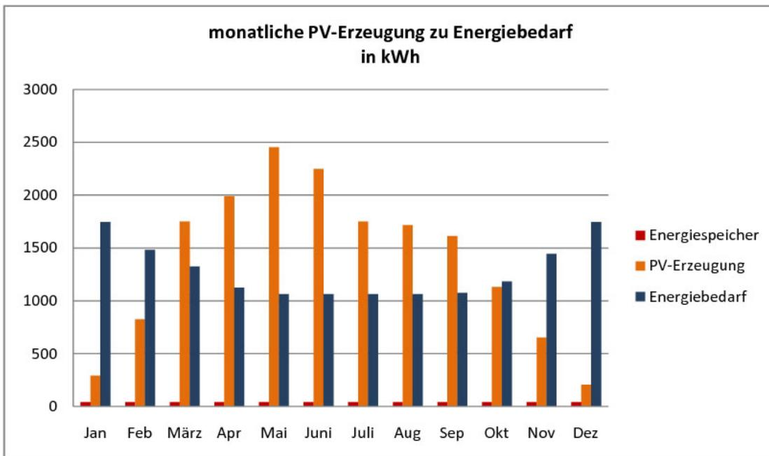
· Das Haus ist damit nicht energieautark. Bei einer detaillierten Betrachtung der **Tagesmengen** wird man feststellen, dass an vielen Wintertagen die Photovoltaik praktisch komplett ausfällt. Die geplante Speicherbatterie mit einer Kapazität von 40 kWh genügt gerade zum Tag-Nacht-Ausgleich im
