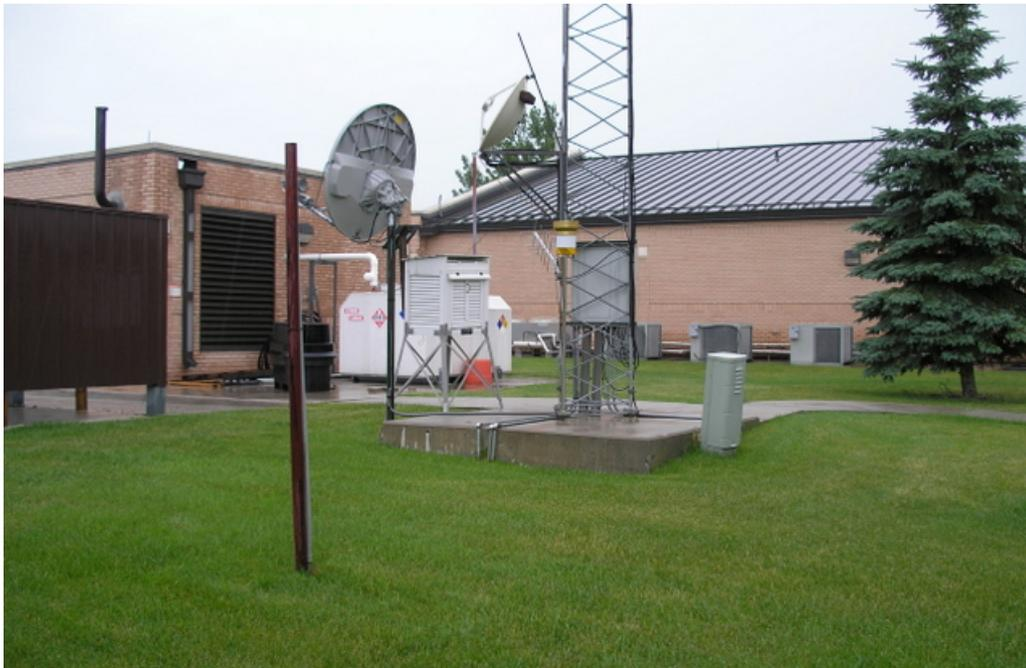
Abb. 6. Die Wetterstation in Grand Forks, North Dakota. Sie liegt am Wettervorhersagebüro der NOAA/NWS Eastern North Dakota. Die Wetterstation (Cotton Region Shelter (CRS)) liegt etwa 3 Meter vor den Belüftungsschlitzen der Klimaanlage für das Büro. Aus [SurfaceStations.org](http://SurfaceStations.org)
