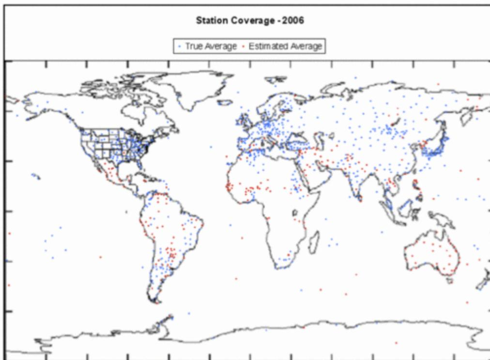
Abbildung 1: Reale Anzahl und Verteilung der einbezogenen GHCN Messstationen 2006. Blau dargestellt mit kontinuierlicher Messung, rot mit diskontinuierlicher Messung. Deren Verteilung in der Vergangenheit [sehen Sie hier](#).
